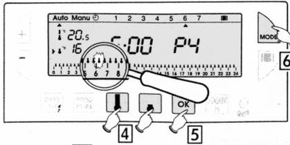
4 Pritisnite **MODE** dok se pokazivač ne premjesti na 06:00. Svakim kratkim pritiskom pokazivač se pomakne za 30 minuta. Duži pritisak ubrzava klizanje pokazivača.
