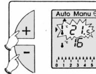
Pokazivač trenutnog nivoa temperature (udobne ili snižene) će početi treperiti. Ova izmjena temperature se poništava kod sljedeće zamjene programiranih temperatura. Da biste se vratili u početni program pritisnite "Mode" i premjestite pokazivač ▲ pod oznaku "Auto".
